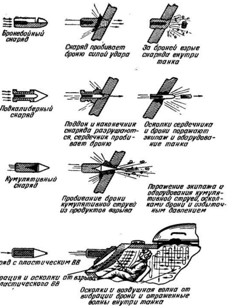
Рис. 18. Действия противотанковых снарядов по броне
