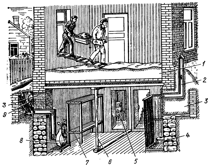
Рис. 62. Приспособление подвала под укрытие (ослабляет действие радиации в 200—600 раз):
