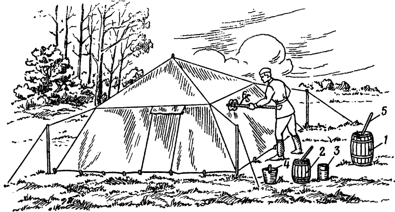
Рис. 114. Пропитка палатки химическим составом ПХС-55:
