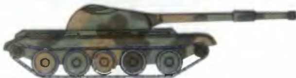
Рис. 1. Деформирующая окраска танка для растительного фона:
