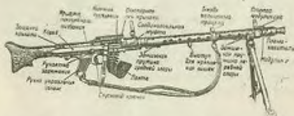
Рис. 63. Пулемет МГ-34, как ручной (на сошке), с ленточным питанием
