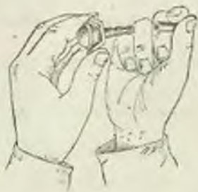
Рис. 75. Надевание детонатора на трубку с замедлителем яцевидной ручной гранаты 39
