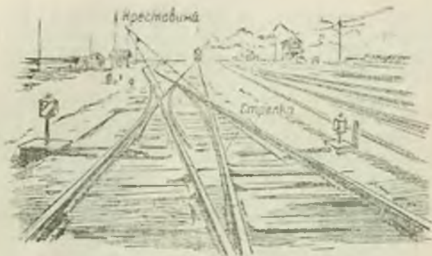
Рис. 21 Стрелки и крестовины на железнодорожном пути у станции
