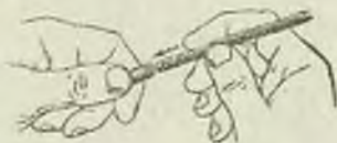
Рис. 45. Соединение капсуля-детонатора с бикфордовым шнуром
