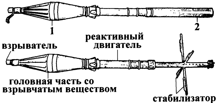
Рис. 337. Основные части выстрела к гранатомету: 1 – головная часть с ВВ; 2 – стартовый пороховой заряд
