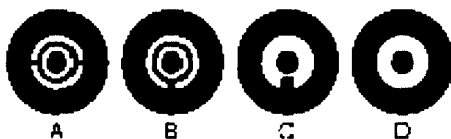
Рис. 286. Различные мушки, применяемые в диоптрических прицелах спортивных винтовок: А и В – кольцевые металлические мушки; С – пеньковая мушка; D – кольцевая стеклянная мушка
