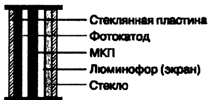
Рис. 317. Схема работы ЭОПа II+ поколения
