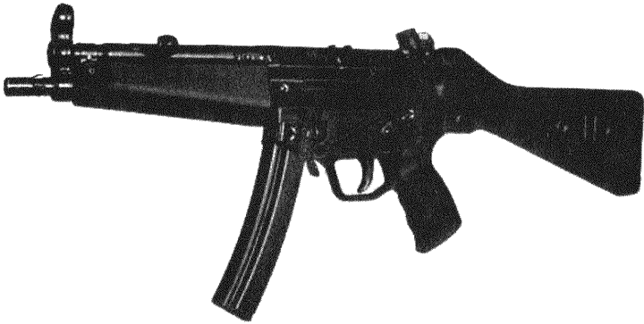
Рис. 204. 9 мм пистолет-пулемет НК МР-5А2 с фиксированным прикладом и цельнопластиковым модулем УСМ с маркировкой "S-E-F" ("безопасно – одиночные – очередь")
