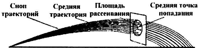
Рис. 385. Сноп траекторий, средняя траектория, площадь рассеивания
