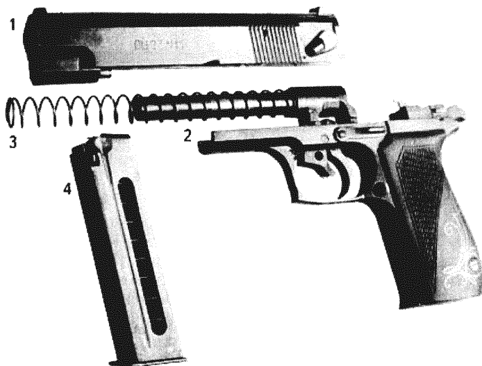
Рис. 107. Неполная разборка пистолета ПСА ОЦ-27 «Бердыш»: 1 – затвор, 2 – рама, 3 – возвратная пружина, 4 – магазин.
