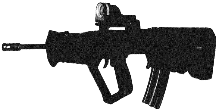
Рис. 296. Автомат (штурмовая винтовка) израильского производства Tavor TAR-21 с коллиматорным прицелом (базовый вариант)
