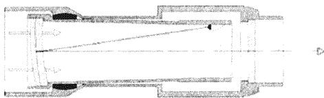
Рис. 290. Принцип работы коллиматорного прицела: красный свет от светодиода отражается назад от передней линзы (двойная линза), весь остальной свет проходит свободно (практически без отражений).
