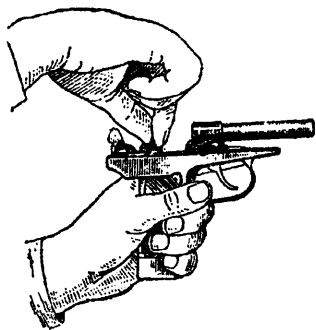
Рис. 27. Присоединение затворной задержки и шептала к рамке
