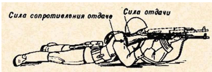
Рис. 59. Подбрасывание дульной части ствола оружия вверх при выстреле в результате действия отдачи
