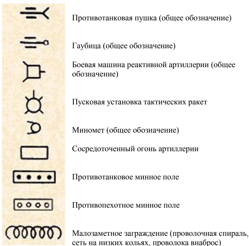
Рис. 2. Условные тактические обозначения основных видов вооружения и боевой техники, применяемых в бою
