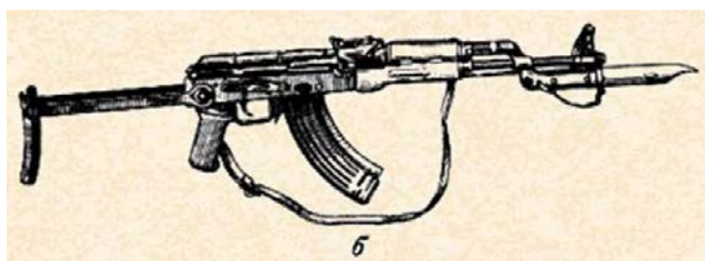
Рис. 25. Общий вид автомата Калашникова; а — с деревянным прикладом (АКМ); б — со складывающимся прикладом (АКМС)
